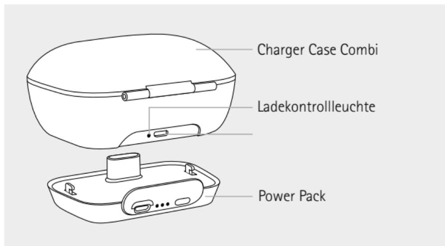
micro-USB-Anschluss an externes Netzteil
