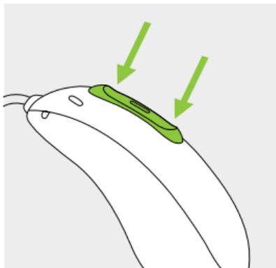
Wenn das Hörgerät mit einem Mobiltelefon mit Bluetooth® Wireless-Technologie gekoppelt ist, können eingehende Anrufe mit einem kurzen Tastendruck auf den unteren oder oberen Teil des Tasters angenommen und mit einem langen Tastendruck abgewiesen werden (siehe Kapitel 13).
