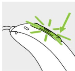
**Telefonieren:** Wenn das Hörgerät mit einem Mobiltelefon mit Bluetooth® Wireless-Technologie gekoppelt ist, können eingehende Anrufe mit einem kurzen Tastendruck angenommen und mit einem langen Tastendruck abgewiesen werden.
